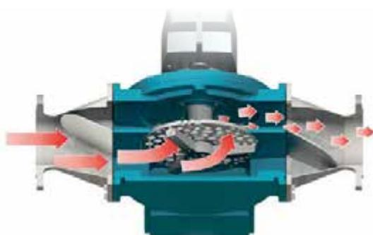
*Multichopper - это измельчитель с центральным перфорированным диском и эффективным лопастным ножом. Он применяется для измельчения твердых веществ в жидких средах. В ассортименте присутствуют три типоразмера измельчителей производительностью до 400 м³/ч.*
