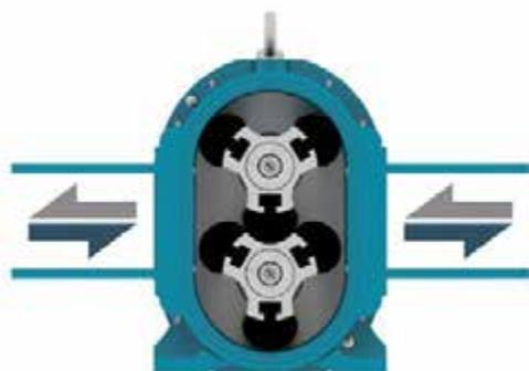
Роторно-лопастные насосы фирмы *Börger* уже более 25 лет применяются для защиты окружающей среды и в коммунальном хозяйстве. Они устойчивы к воздействию твердых включений, надежны и энергоэффективны. Насосы *Börger* без проблем перекачивают жидкости с илом, абразивом и высоким содержанием твердых частиц.
