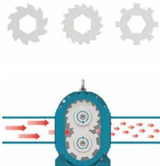
Двухвальный измельчитель Multicrusher эффективно и надежно перемалывает твердые включения, обеспечивая безопасную и бесперебойную работу насосов и другого оборудования, находящегося дальше по технологической линии.
